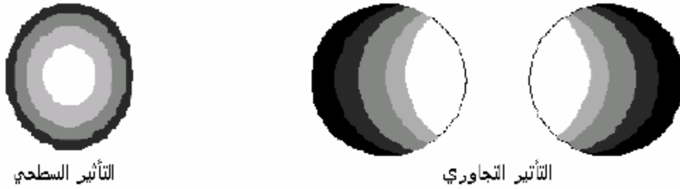
شكل 2-8 : التأثير السطحي ( Skin effect ) و التأثير التجاوري ( Proximity effect )
